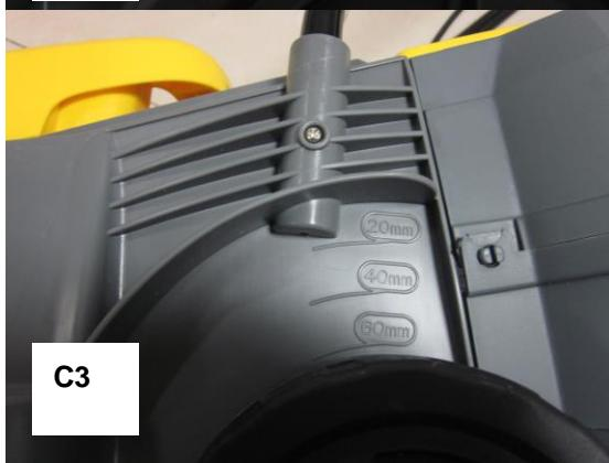
Подесувањето на висината на косење се регулира со спуштање и подигање на тркалцата.(C1&C2&C3)
